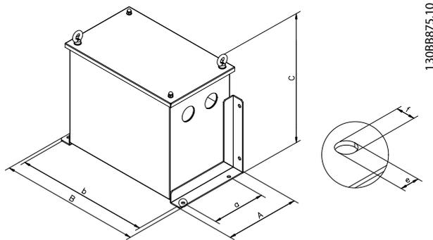
Ilustración 5.11 IP54 con montaje en suelo / pared
