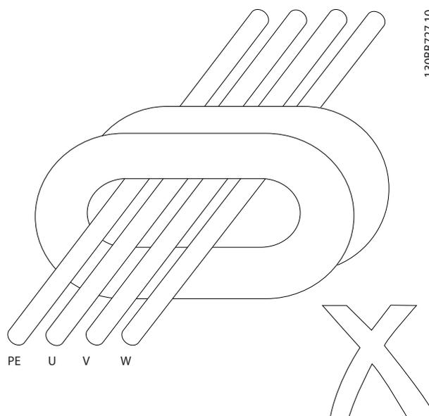
Ilustración 5.2 Instalación incorrecta. La conexión a tierra de protección no debería atravesar el núcleo.
