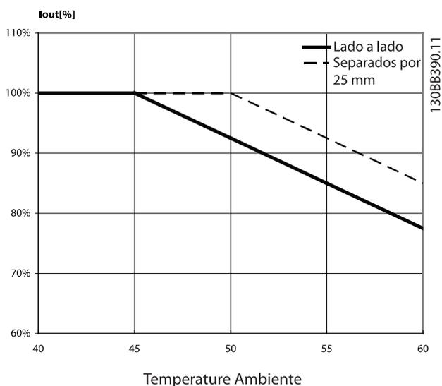
Ilustración 4.2 Reducción de potencia por temperatura
