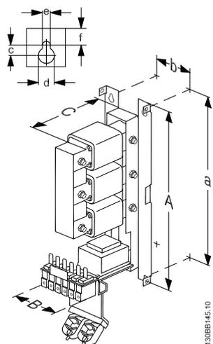
Ilustración 5.4 IP00 con montaje en pared
