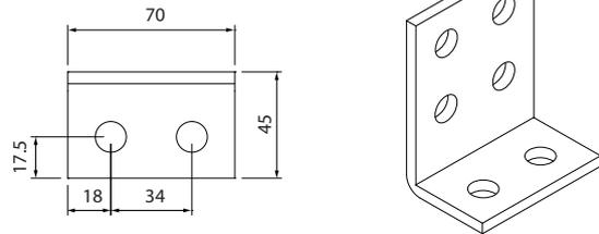
Ilustración 5.16 Kit de terminal en forma de L 130B3138
