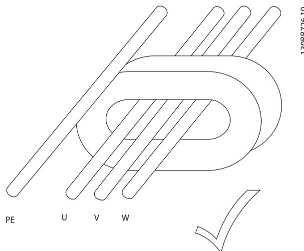
Ilustración 5.1 Instalación correcta
