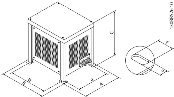
Ilustración 5.14 IP23 con montaje en suelo
