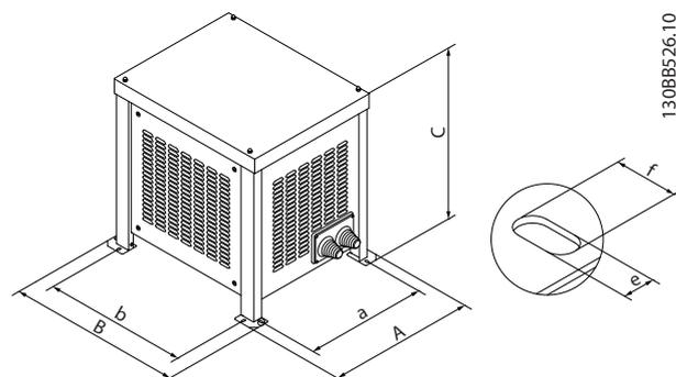
Ilustración 5.12 IP23 con montaje en suelo
